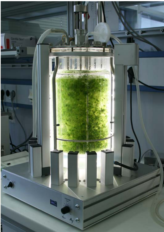
Ein Bioreaktor zur Massenvermehrung von Torfmoos aus der Gattung Sphagnum. © ReskiLab, Universität Freiburg
